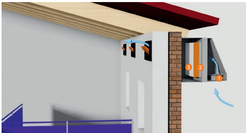
Схема работы APT 1500 для децентрализованной подачи притока через стенной клапан CL 1200
